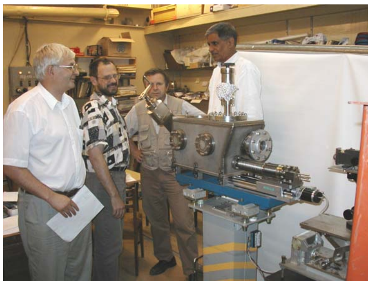
Рис. 22. Двухкристальный монохроматор с фиксированным положением пучка на выходе.
